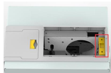
注：清洁轮的作用是吸附进卡轮的灰尘与异物，间接吸收卡片灰尘与异物，阻挡灰尘进入打印机的走卡轨道中，从而有效提升打印效果。
