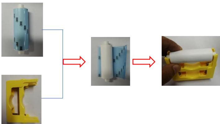
撕开清洁轮表面 3M 胶层后，用手拿清洁轮两头，推放到安装位置后轻轻往下按压，锁住清洁轮两端不脱落即可。
