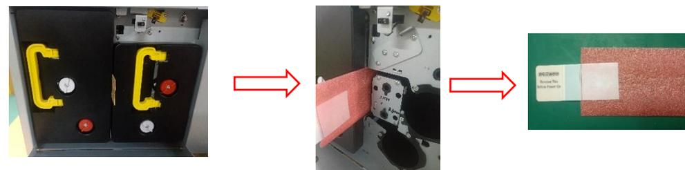
(2) 将色带和转印膜组装到耗材架子中：
