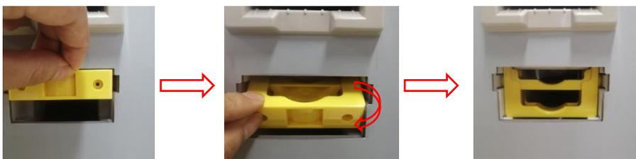
以上步骤完成后，然后再关闭清模块门盖，即完成清洁模块（下）的安装。
