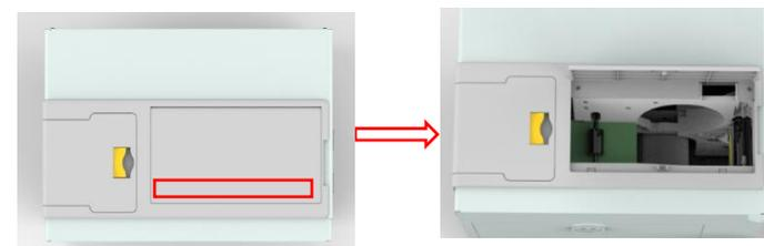
(3) 将上述组装好的清洁模块，按以下图示轻轻按压下去，安装到证卡打印机中，然后再关闭上盖门，即完成清洁模块（上）的安装。
