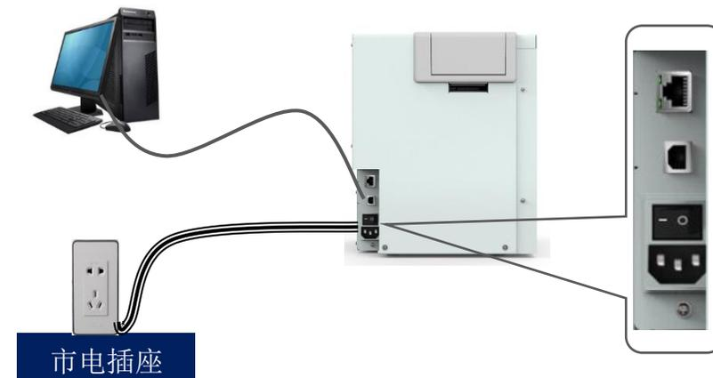
以太网通讯接口安装方式：RJ45 网络接口，568B 接线方式。
